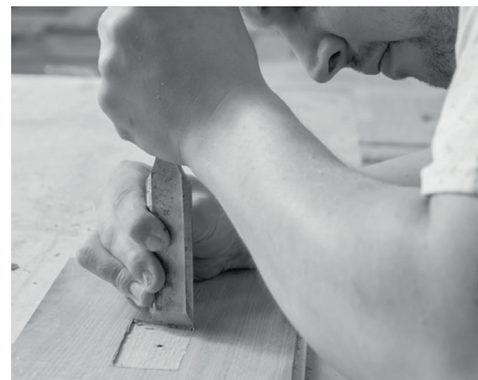
Applicazione degli inserti in acciaio. Applying the steel inserts.
