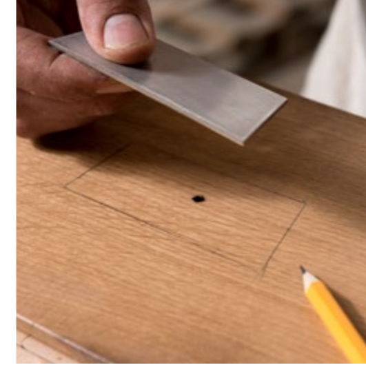
Particolari della tassellatura in acciaio delle tavole recuperate da vecchie travi
