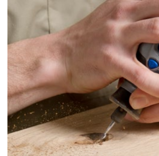
Preparazione dei nodi per la stuccatura
