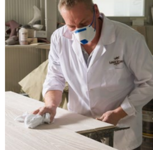
Tecnica di "stracciatura a mano" del colore
