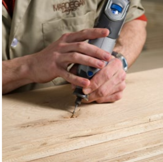
Preparazione dei nodi per la stuccatura
