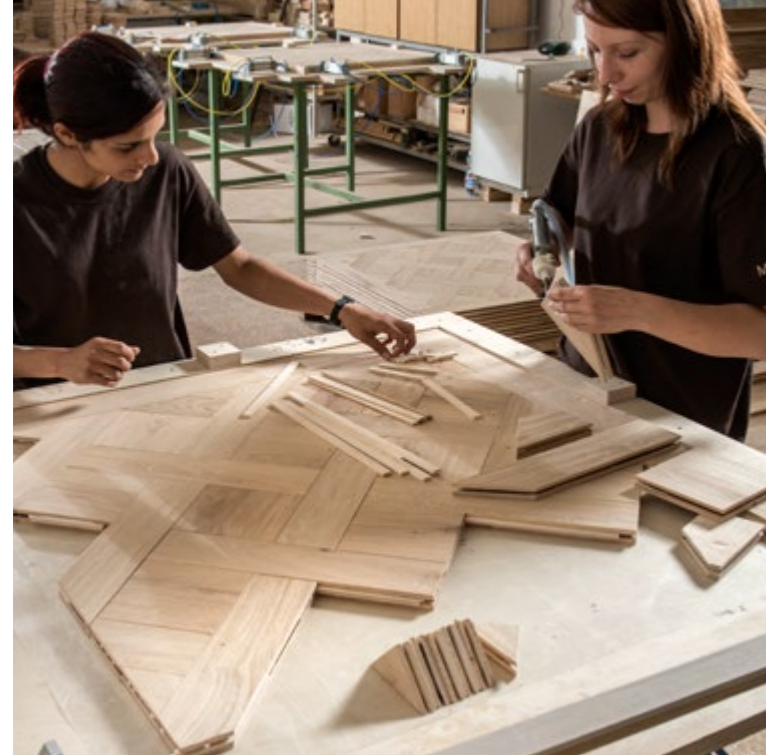
Assemblaggio a mano delle Quadrotte
