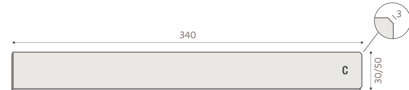
Bordura laterale pedata sp 5,2 mm
