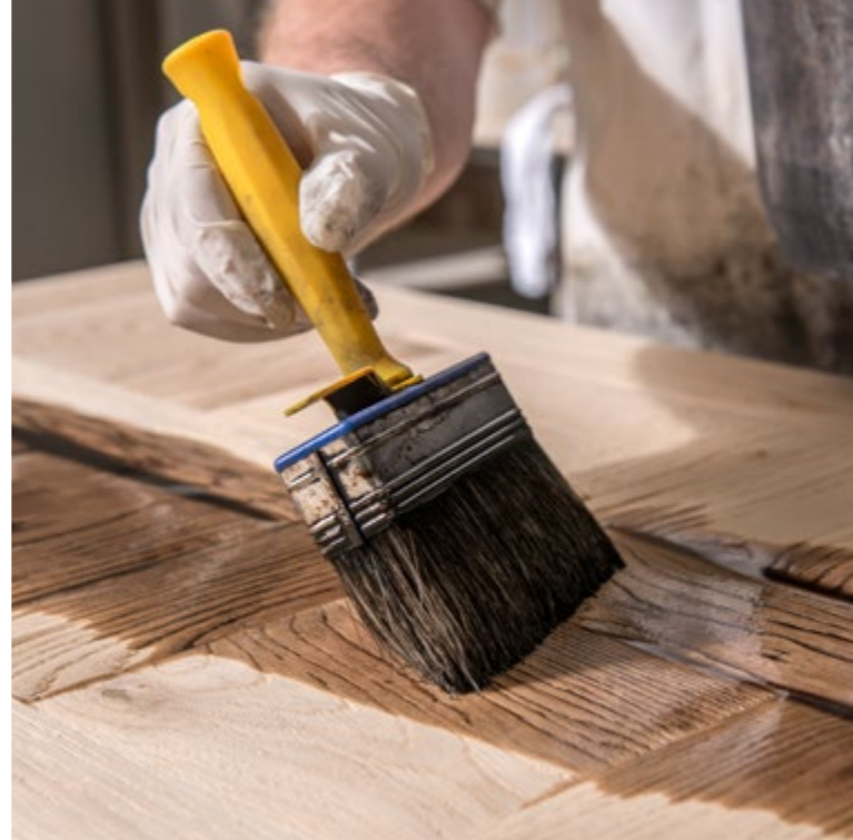
Tecnica di "colorazione a pennello" con reagenti
