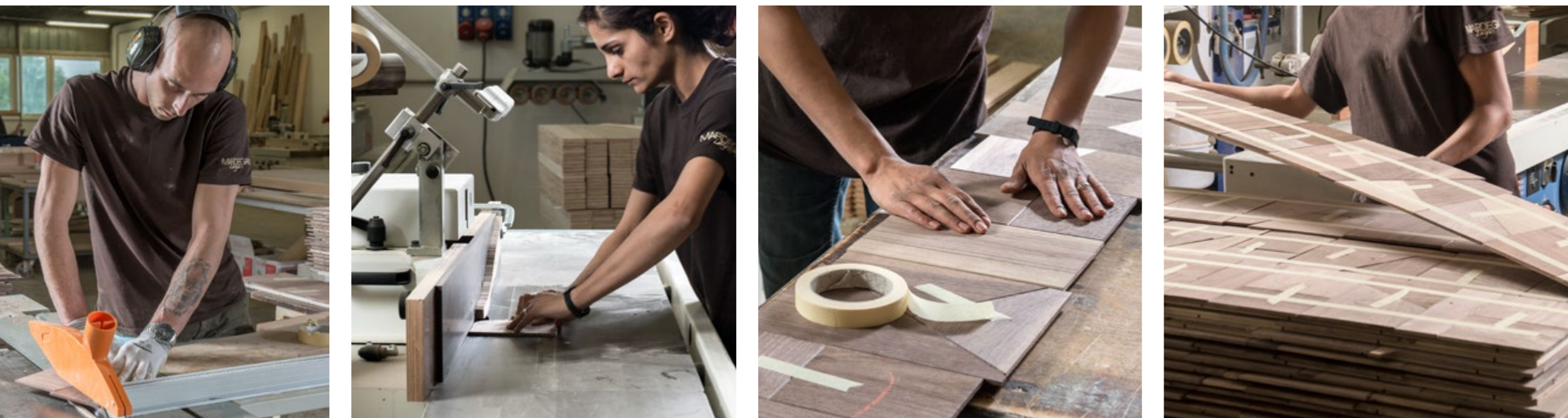
Particolari delle fasi di lavorazione manuale per il taglio, la bisellatura e l'assemblaggio delle tavole Teorema
