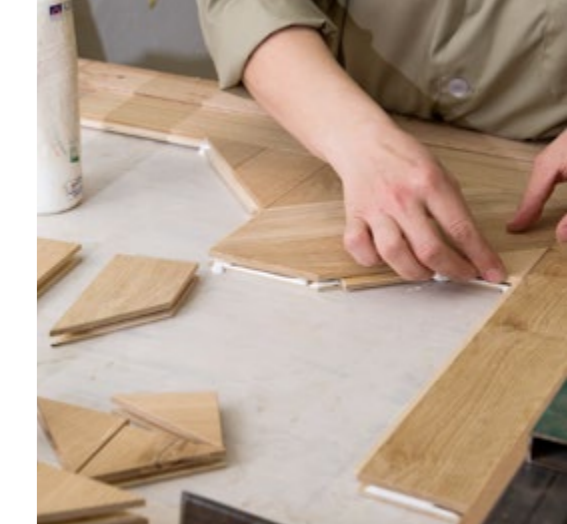
Assemblaggio a mano delle Quadrotte
