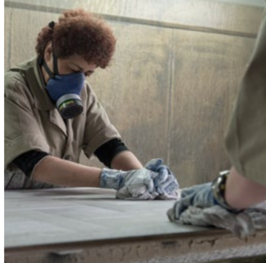
Tecnica di "stracciatura a mano" del colore
